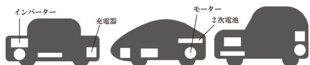
図1 電気自動車の部品レイアウト [3]
