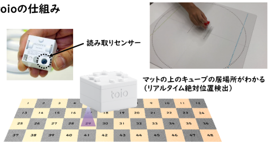
図 5 : 絶対位置検出の仕組み
