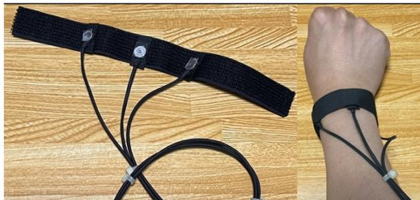
図 1 振動モーターと装着イメージ
